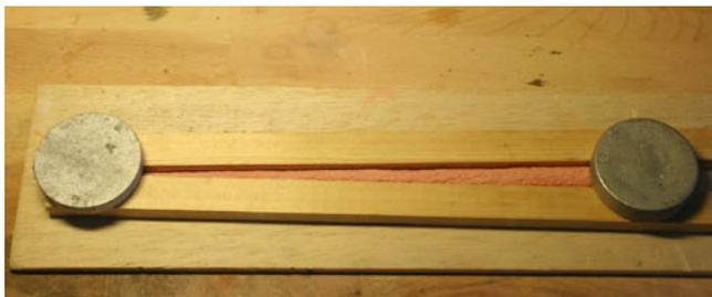
La terre cuite a tendance à se déformer en séchant et, pour éviter ce problème, je cale le tronc entre deux morceaux de bois. (Photo de gauche).
