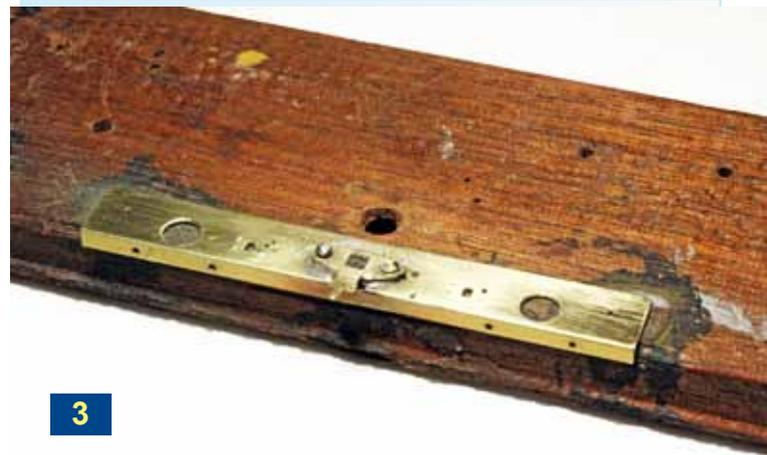
Braser ou coller avec de la colle bi-composant les tampons préalablement dégrappés en prenant soin de laisser une partie de la carotte, ce qui permet de renforcer en cas de collage. Réaliser les mains d'attelage (pièces en U) avec du rond Ø 0.5. Elles dépassent de 8 mm. Braser par l'intérieur dans les trous Ø 0,6 mm. S'aider d'une cale pour qu'elles soient parallèles à la traverse. Agrafer les brasures.
