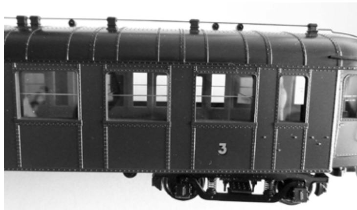
Les voitures ont été équipées de mains courantes en fil de maillechort de 0,5 mm. J'avais ce diamètre dans ma réserve ; 0,6 (diamètre des mains montoires), voire 0,7 aurait été préférable.
