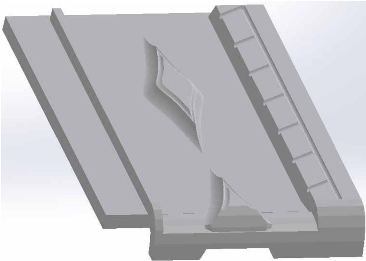
Ci-contre le dessin détaillé et modélisé d'une tuile.
